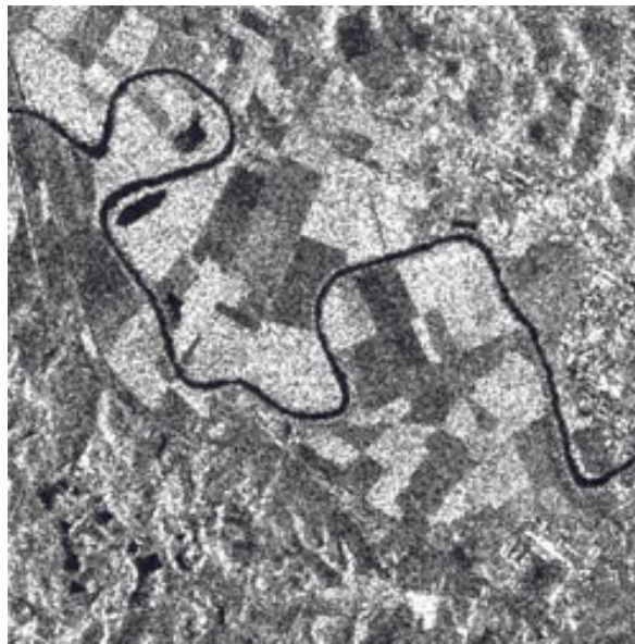
FIGURE 2.4 – Présence du speckle dans une image SAR sur une zone agricole de la Vallée du Tibre, Italie (source ESA)
