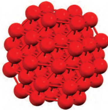
FIGURE 1.14 – Nanoparticule de fer constituée de 59 atomes cristallisant dans la phase cubique centré .
