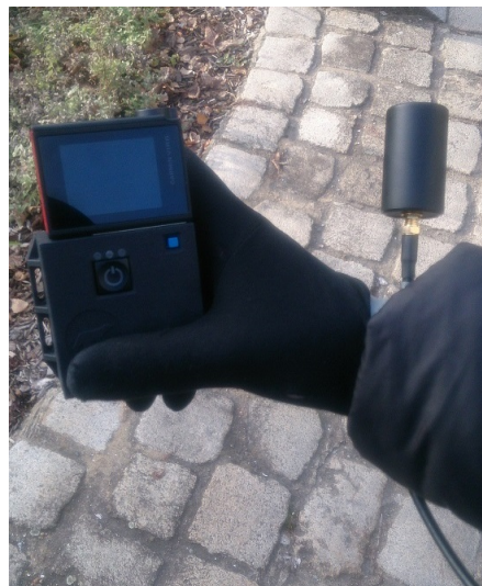
FIGURE 5.5 – Matériel expérimental du piéton, antenne hélicoïdale attachée au poignet et récepteur GNSS géodésique dans le sac à dos durant les acquisitions.
