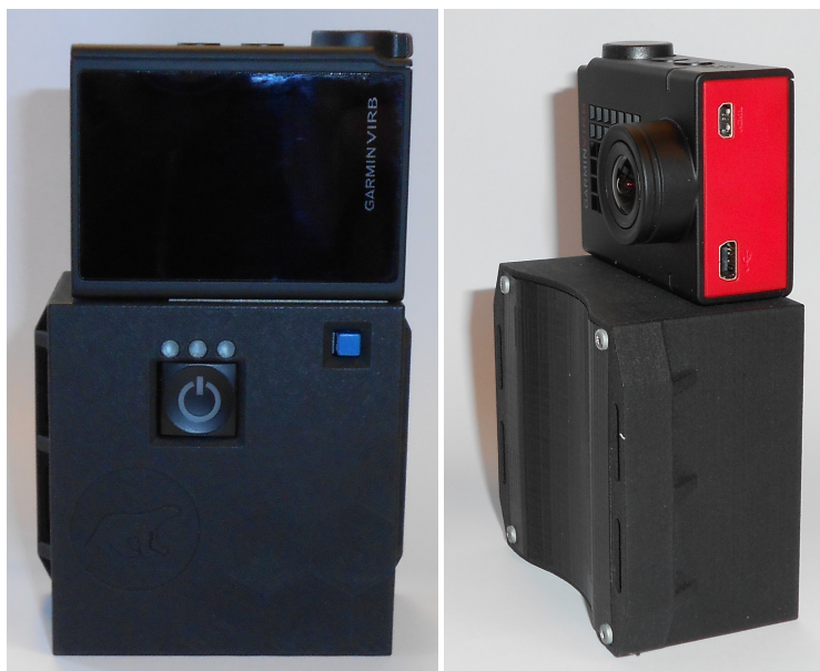
FIGURE 2.9 – Plateforme d'acquisition : la plateforme ULISS et la caméra monoculaire Garmin VIRB.
