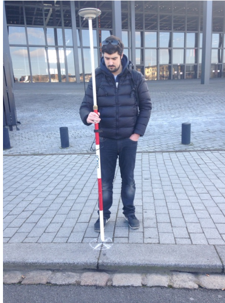
FIGURE 4.15 – Acquisition avec récepteur GNSS géodésique, antenne pour déterminer la position des points de référence et canne à bulle.
