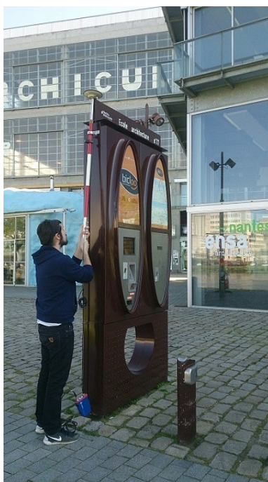
FIGURE 4.10 – Acquisition de la position des bords du terminal de la station vélo avec récepteur GNSS géodésic double fréquence et antenne.
