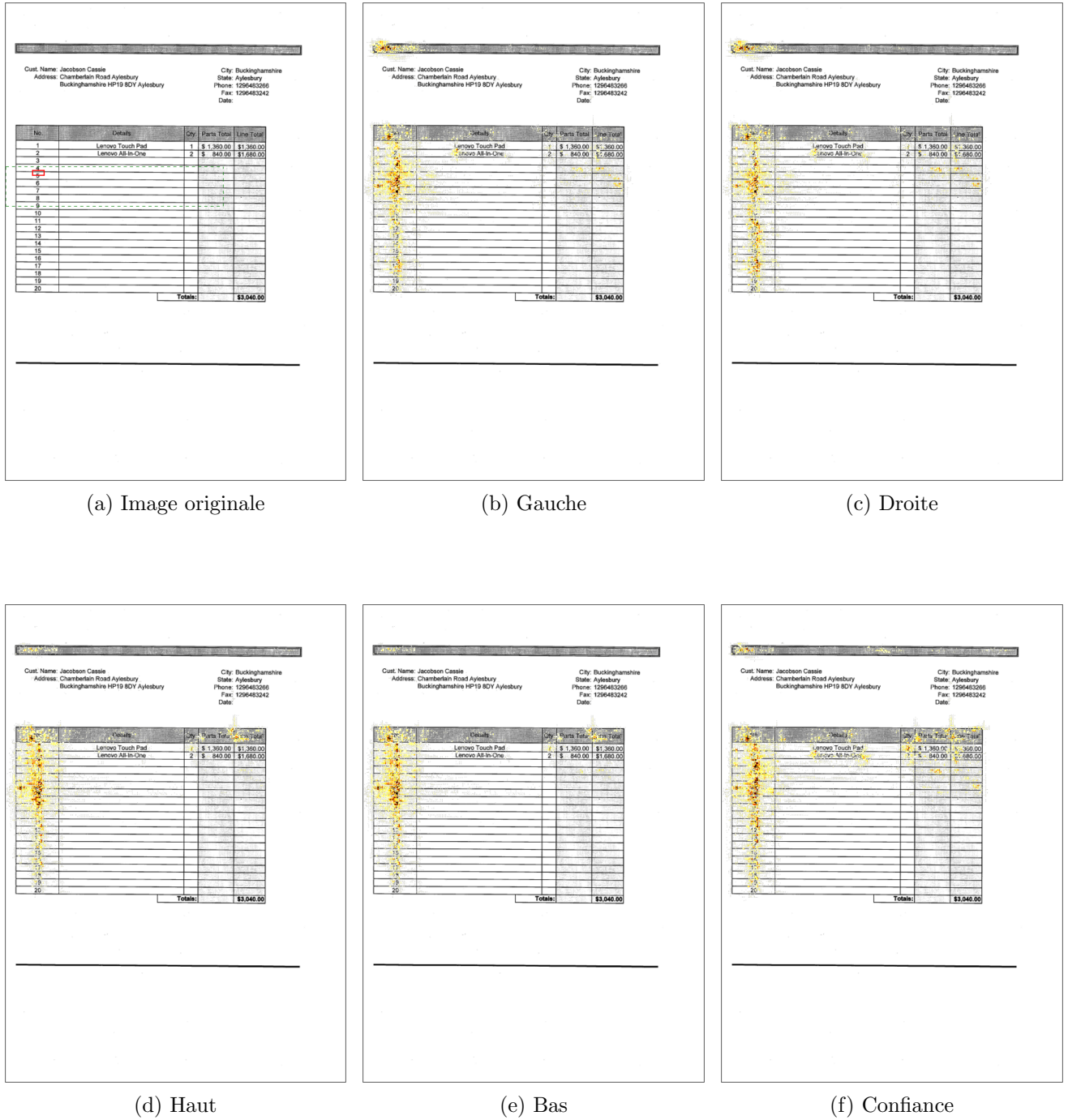
Fig. 8.12 – Visualisation de la rétro-propagation de gradients dans l’espace de l’image d’entrée pour les sorties relatives aux positions b) de la gauche c) du haut d) de la droite e) du bas ou f) de la confiance. La boîte correspondant à ces sorties est affichée en rouge dans l’image d’entrée (a) et son champs réceptif convolutionnel en pointillés verts.
