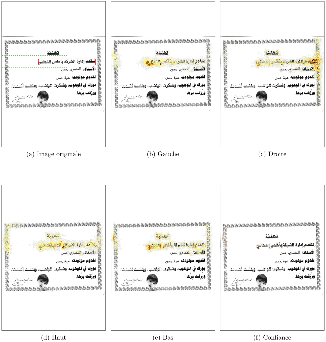
Fig. 8.7 – Visualisation de la rétro-propagation de gradients dans l'espace de l'image d'entrée pour les sorties relatives aux positions b) de la gauche c) du haut d) de la droite e) du bas ou f) de la confiance. La boîte correspondant à ces sorties est affichée en rouge dans l'image d'entrée (a) et son champs réceptif convolutionnel en pointillés verts.
