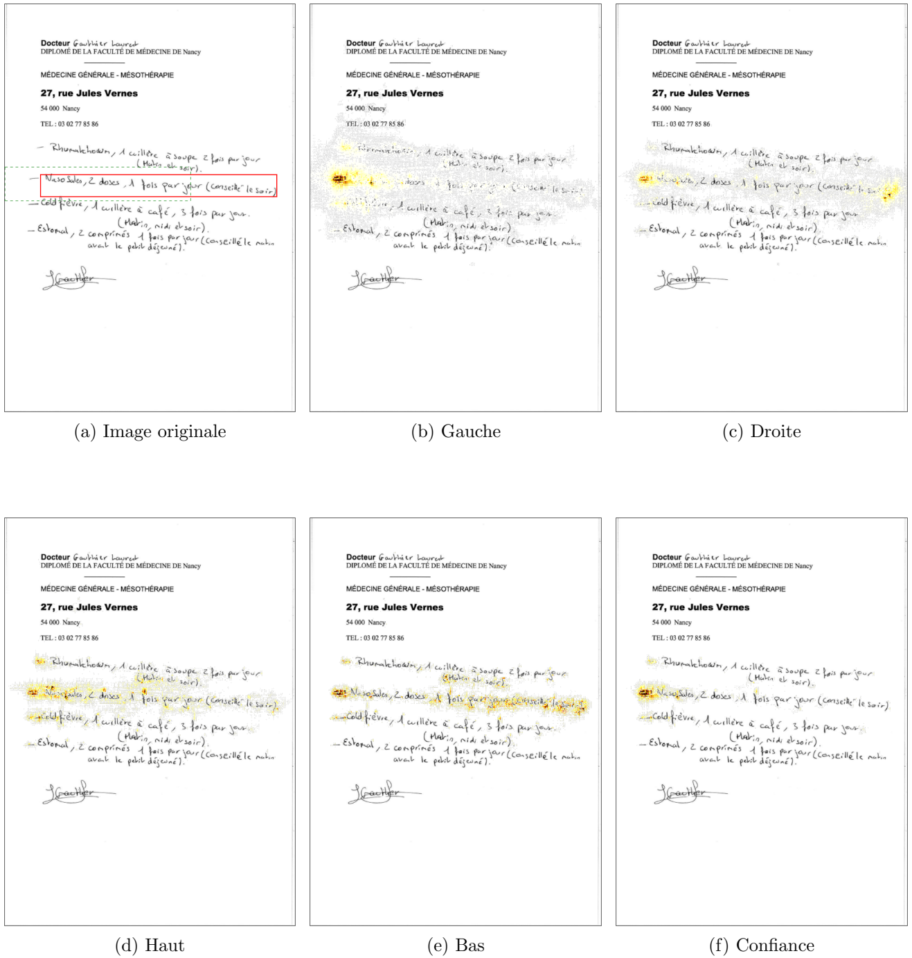
Fig. 8.8 – Visualisation de la rétro-propagation de gradients dans l’espace de l’image d’entrée pour les sorties relatives aux positions b) de la gauche c) du haut d) de la droite e) du bas ou f) de la confiance. La boîte correspondant à ces sorties est affichée en rouge dans l’image d’entrée (a) et son champs réceptif convolutionnel en pointillés verts.
