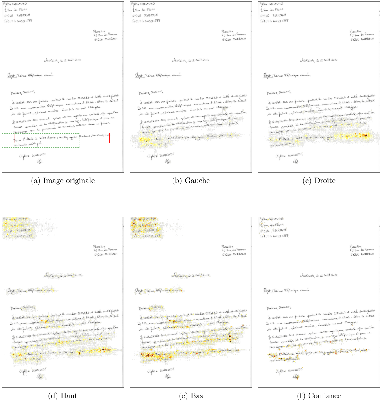
Fig. 8.10 – Visualisation de la rétro-propagation de gradients dans l’espace de l’image d’entrée pour les sorties relatives aux positions b) de la gauche c) du haut d) de la droite e) du bas ou f) de la confiance. La boîte correspondant à ces sorties est affichée en rouge dans l’image d’entrée (a) et son champs réceptif convolutionnel en pointillés verts.
