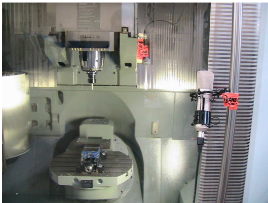
Chaine d'acquisition acoustique
