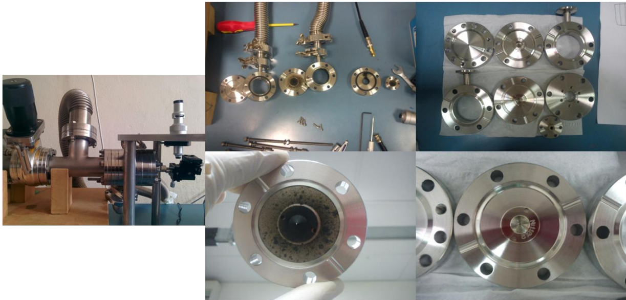
Figure III-21 : photos du sas de décompression monté et démonté avant et après nettoyage.
