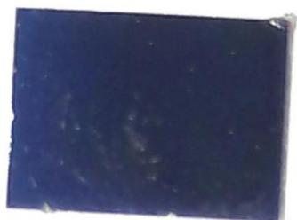
Figure III-27 : Photo du film STLTO-32 déposé avec  $\%O_2 = 0$  par pulvérisation cathodique sur substrat MgO
