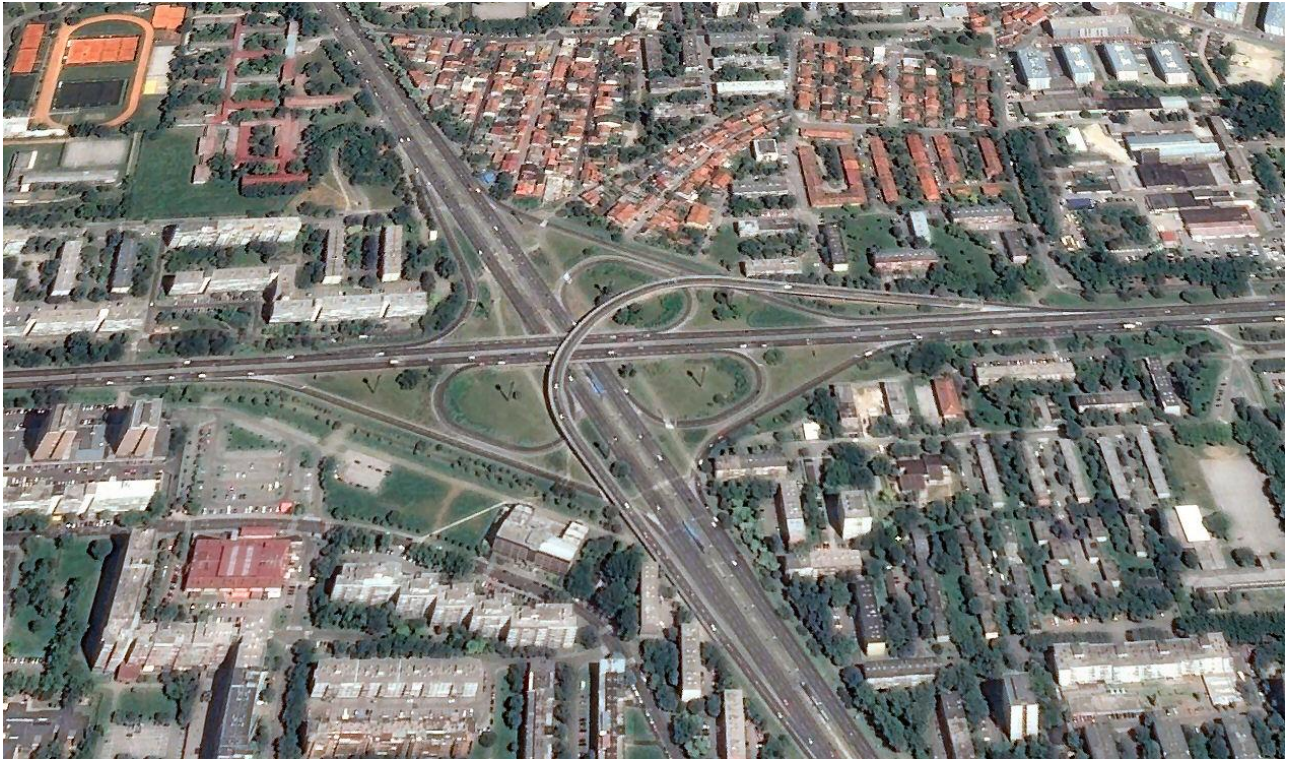
Ilustracja 128 Zagrzeb – węzeł arterii miejskich (3 poziomy) Źródło: Google Earth 12/06/2014
