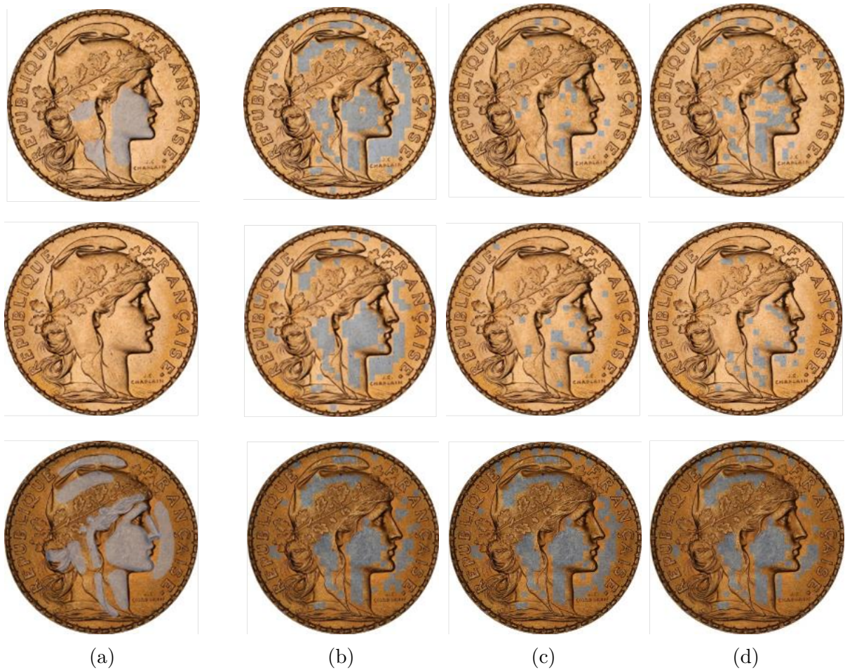
FIGURE 7.19 – Zones granuleuses (marquées en gris) sur trois exemples de monnaies : (a) annotation manuelle faite par la société GENI; (b) (c) (d) zones granuleuses détectées par le réseau entraîné en utilisant respectivement les imagerie en couleur (b), en niveaux de gris (c) et en niveaux de gris normalisés (d)
