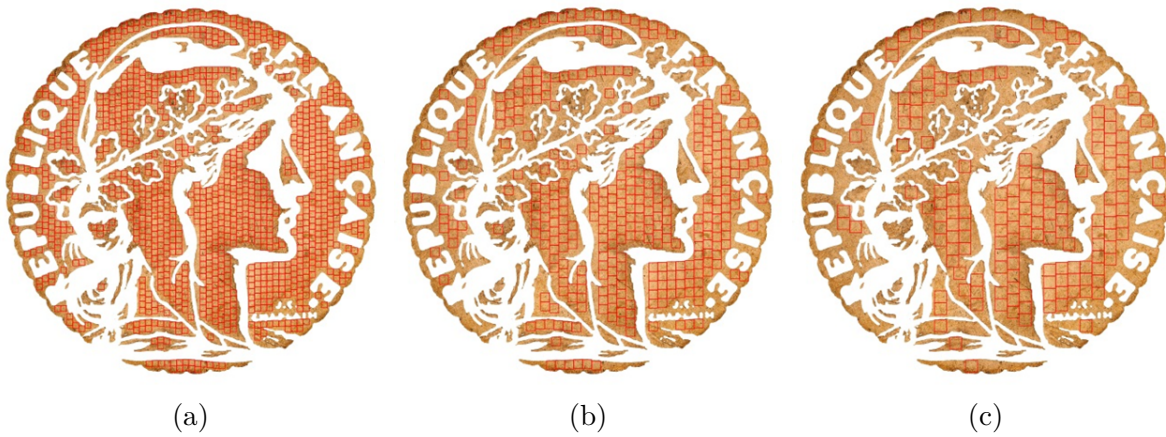
FIGURE 7.11 – Division de la zone d'intérêt en imagerie de différentes tailles fixées : (a) 32 \times 32 pixels ; (b) 48 \times 48 pixels ; (c) 64 \times 64 pixels
