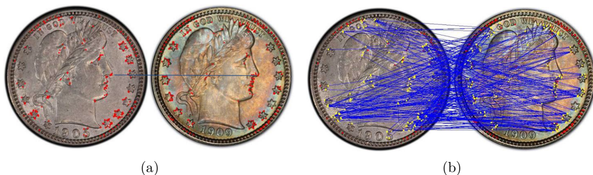
FIGURE 5.4 – Détection et appariement des points d'intérêt ORB sur deux monnaies US Barber Quarter obv. (points rouges : points d'intérêt détectés non appariés ; points jaunes : points d'intérêt appariés) : (a) une paire des points d'intérêt appariés sur les nez du portrait ; (b) appariement naïf de tous les points d'intérêt en utilisant un seuil de distance.
