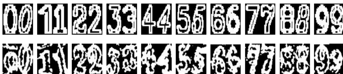
FIGURE 6.12 – Exemples de chiffres synthétiques testés (en haut) et de cartes des gradients binarisées obtenues sur la base CoinNUMS_pcgs_a (en bas)
