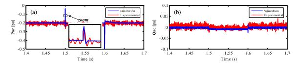
Figure-9: Comparaison entre les résultats de simulation et les résultats expérimentaux pour un creux symétrique de tension AC (50%): (a) la variation de la puissance active, (b) la variation de la puissance réactive.
