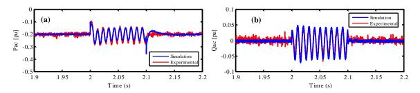
Figure-10: Comparaison entre les résultats de simulation et les résultats expérimentaux pour un creux asymétrique de tension AC (50%): (a) la variation de la puissance active, (b) la variation de la puissance réactive.
