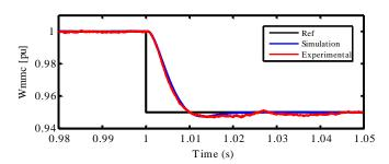
Figure-8: Comparaison entre les résultats de simulation et les résultats expérimentaux pour un échelon sur l'énergie interne du MMC.
