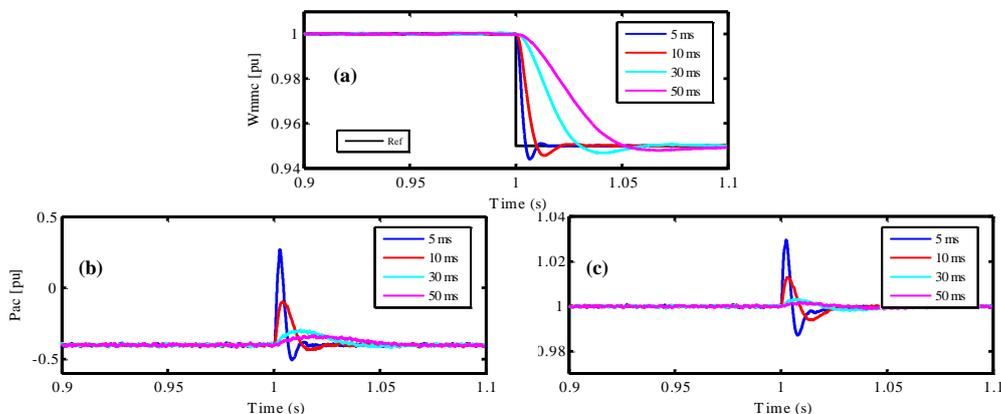
Figure-7: Résultats de simulation pour un échelon sur l'énergie interne du MMC: (a) énergie stockée dans le MMC, (b) la variation de la puissance active, (c) la variation de la tension du bus DC.
