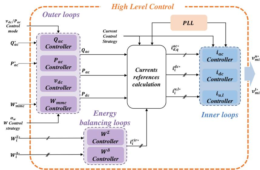
Figure-4: Schéma de contrôle retenu pour l'étage supérieur.
