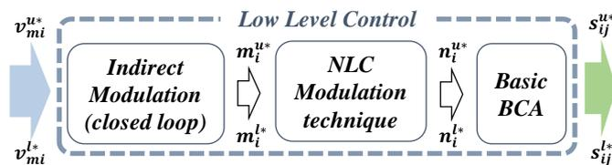
Figure-5: Schéma de contrôle retenu pour l'étage inférieur.
