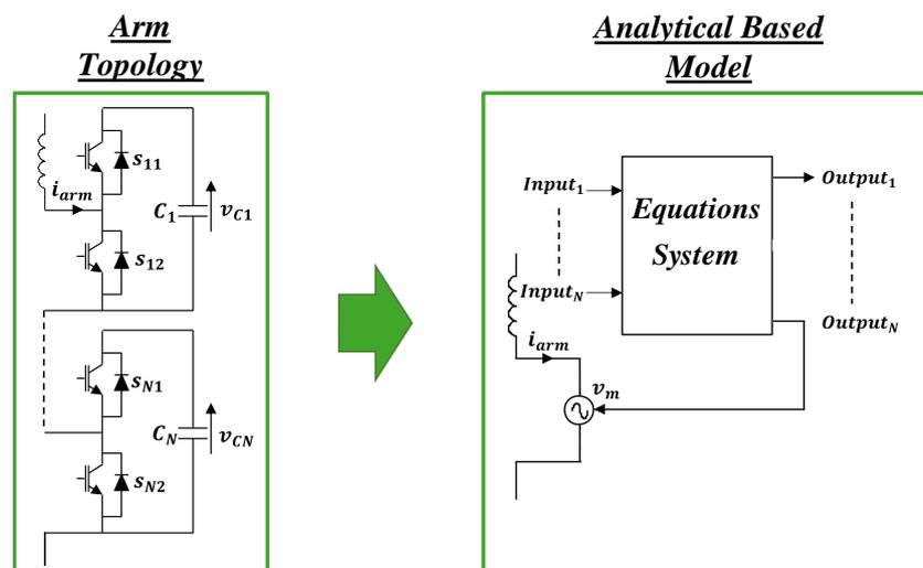
Figure-3: Le modèle analytique proposé pour un bras du MMC.
