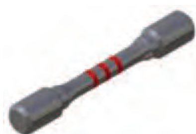
Figure II-15 : Découpe d'échantillons de 0.5 mm d'épaisseur (en rouge) dans une éprouvette de traction pour observation par MET
