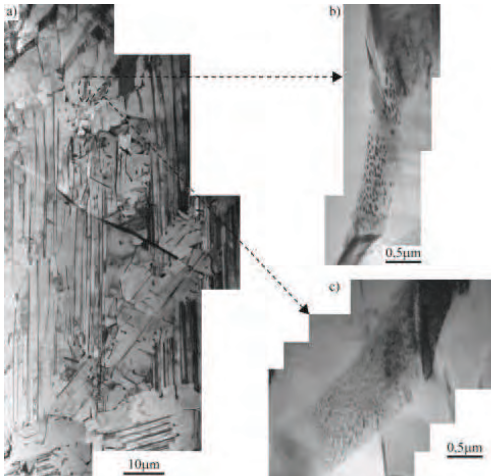
Figure V-32 : Microstructure proche lamellaire de l'alliage IRIS après environ 2% de déformation en fluage à 700°C sous 300MPa. a) Portion de grain lamellaire entouré du liseré. b) et c) Agrandissements d'un grain \gamma du liseré où apparaissent des précipités.
