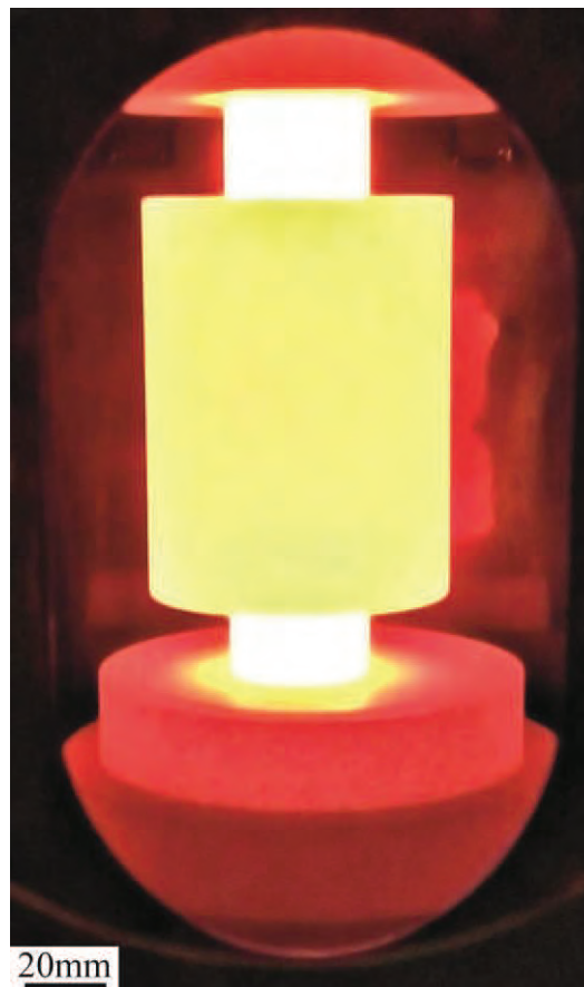
Matrice et pistons en graphite chauffés à plus de 1300°C dans l'enceinte du SPS.
