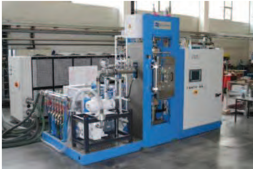
Figure I-7 : Machine SPS FCT HPD-125 installée à l'ICB à Dijon.
