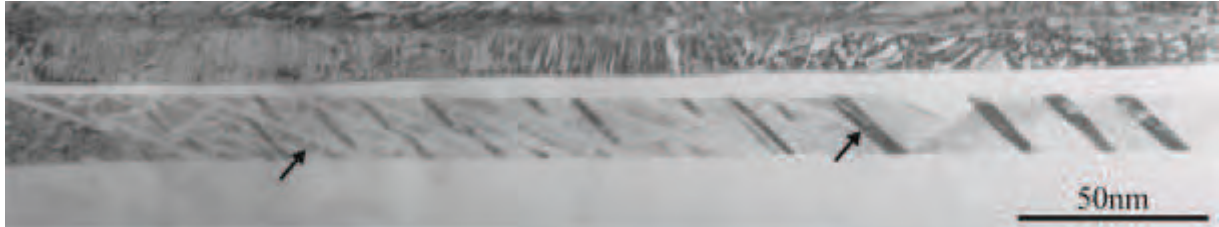
Figure IV-15 : Précipités \beta_0 (flèches noires) présents à l'interface entre lamelles \gamma et \alpha_2 (alliage IRIS).
