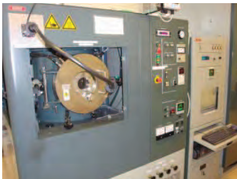
Figure II-6 : Machine SPS Sumitomo 2080 installée à la PNF 2 à Toulouse.
