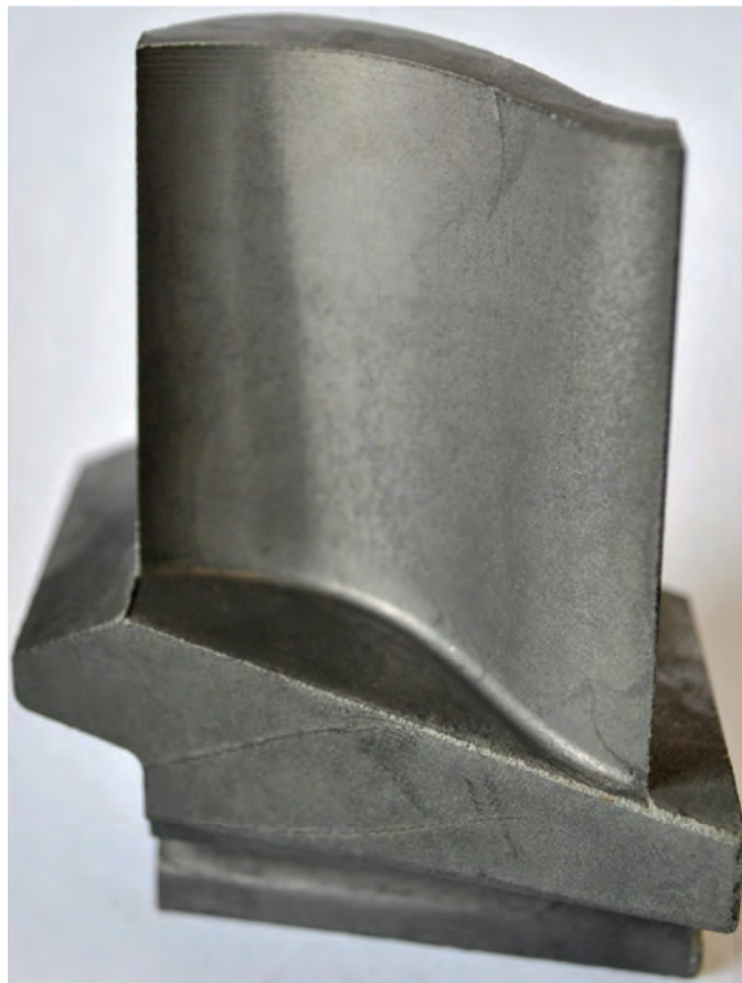
Aube de turbine de turboréacteur d'avion densifiée par SPS.
