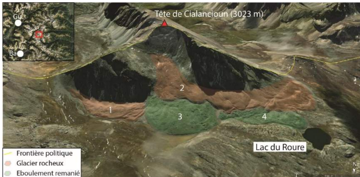
Figure 22829 : Interaction de processus dans l'évolution d'un versant : l'exemple de la Tête de Cialancioun (3023 m). Code : 114Cham, p. 714 de l'Atlas. Les zones 1 et 2 sont interprétés comme des phénomènes de glaciers rocheux. Les zones 3 et 4, quant à elles, sont interprétées comme des éboulements remaniés par la glace et antérieurs aux zones 1 et 2. Gu : Guillestre ; Ba : Barcelonnette.
