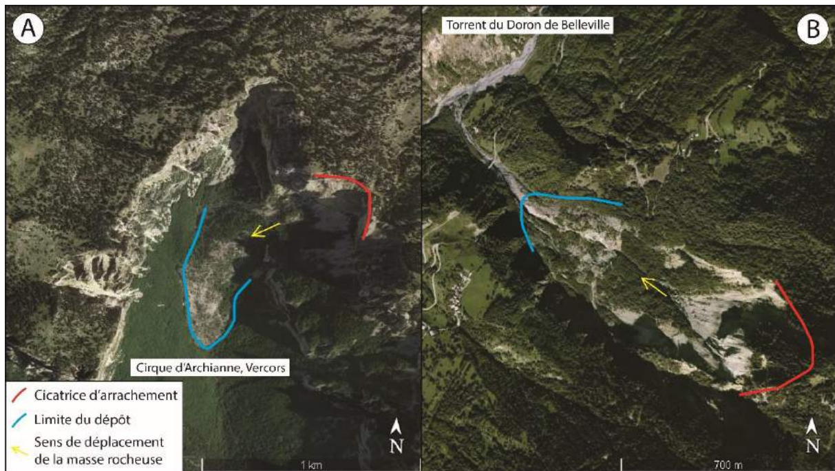
Figure 96 : Exemple de RVR sur des roches sédimentaires chimiques et biochimiques. A : EAR dans le cirque d'Archianne (massif du Vercors) (Marcel et al, 2013) (code : 3Ve, p. 1445 de l'Atlas) ; B : GR dans les gypses et cargneules dans le massif de la Vanoise (code : 105Va, p. 1409 de l'Atlas).
