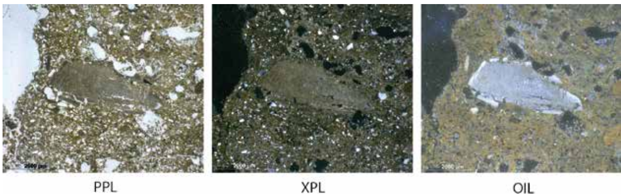
Figure V.64: Régismont-le-Haut, lame mince RGT14 79F11 S. Gravier calcaire chauffé du sommet rubéfié du faciès [1].
