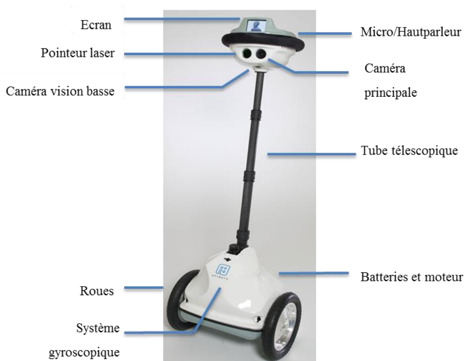
Illustration 1: Robot de téléprésence QB
