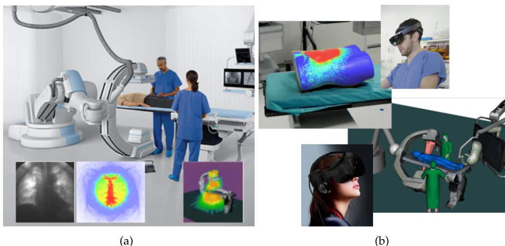
Figure 31 – Le projet ANR Optimix : (a) optimisation de la position du système d'imagerie par rayons X afin de minimiser la dose d'irradiation reçue par le patient et le personnel médical, (b) visualisation 3D par réalité augmentée/virtuelle des zones d'irradiation en procédure chirurgicale guidée par rayons X pour l'éducation et l'enseignement.
