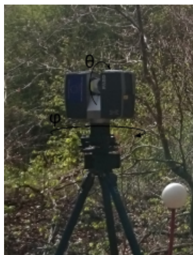
(a) Illustration de scanner Faro Focus 3D X130 avec la rotation zénithale ( \theta ) et la rotation azimutale ( \phi )
