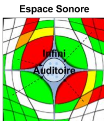
Figure 8.2. Représentation de la deuxième possibilité de relation entre l'espace sonore sous sa forme matricielle et un auditoire associé à l'espace réel de restitution. Les flèches représentent la manière dont les soxels doivent être projetés vers l'auditoire. Les deux espaces se superposent et la distance est infinie. Aussi l'espace réel de restitution apparaît comme infiniment loin « au centre » de l'espace sonore matriciel. Alors seules les informations directionnelles des soxels par rapport au centre de l'espace sonore matriciel, sont considérées dans l'opération de projection.
