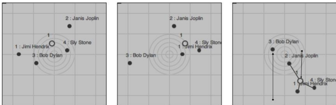
Figure 3.8. Représentation d'interactions de l'utilisateur sur des interfaces graphiques hoa2/3d.map dans le logiciel Pure Data. Les interactions se lisent de gauche à droite. Les interfaces d'en haut représentent une vue du dessus (les axes x et y) et sont liées aux interfaces d'en bas qui représentent une vue frontale (les axes x et z), afin d'avoir un aperçu tridimensionnel. Les points noirs numérotés de 1 à 4 représentent les sources sonores. Le cercle numéroté 1 représente un groupe comprenant les sources 1, 2 et 4. Des interfaces de gauche aux interfaces du centre, une opération de rotation (où la distance est contrainte) sur le groupe, et donc sur ses sources, est réalisée via la vue du dessus. La source 3 subit quant à elle une translation. Ces déplacements se répercutent automatiquement sur la vue frontale par une modification des sources sur l'axe x. De l'interface du centre aux interfaces de droite, le groupe subit une translation vers le bas et la source 3 subit une translation vers le haut via la vue frontale en contraignant l'axe des x. Ces modifications impliquent que la hauteur ne soit pas visible sur la vue du dessus.
