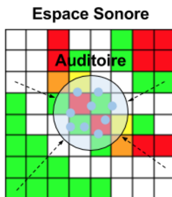
Figure 8.4. Représentation de la troisième possibilité de relation entre l'espace sonore sous sa forme matricielle et un auditoire associé à l'espace réel de restitution. Les flèches représentent la manière dont les soxels doivent être projetés vers l'auditoire. Les deux espaces sont superposés et la distance entre les soxels et l'espace réel de restitution est finie. Aussi, les contributions des soxels apparaissent sous la forme d'un ensemble de signaux provenant de multiples directions enveloppant l'espace réel de restitution, à des distances différentes.
