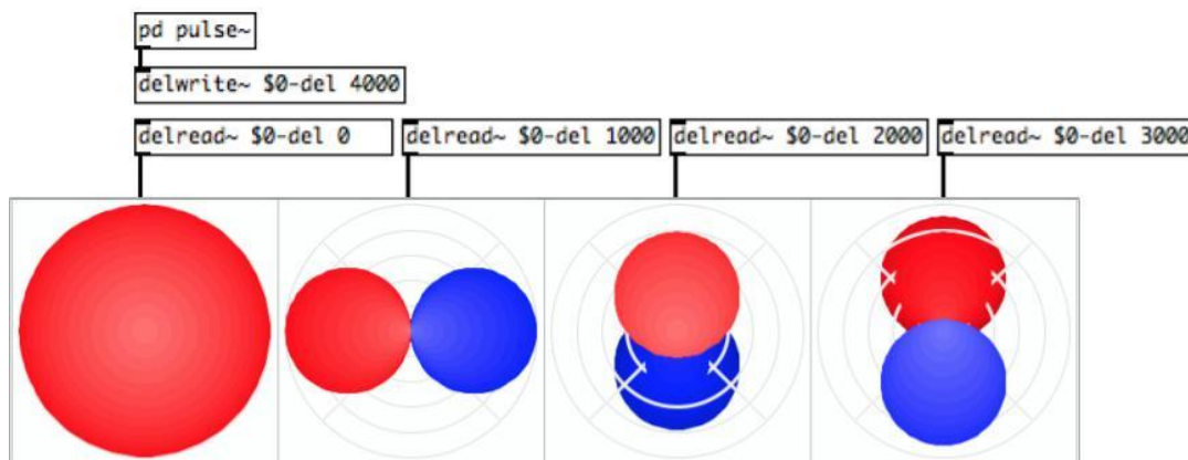
Figure 4.5. Synthèse des signaux associés aux harmoniques sphériques d'ordre de décomposition 1 par décorrélation temporelle selon des temps de retard croissants tels que t_{0,0} < t_{1,-1} < t_{1,0} < t_{1,1} . Les représentations via l'objet hoa.3d.scope~ représentent les contributions du champ sonore à ces quatre temps.
