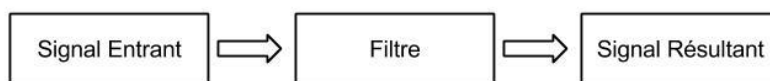
Figure 8.6. Représentation la plus générale de l'opération d'un filtre en traitement du signal.
