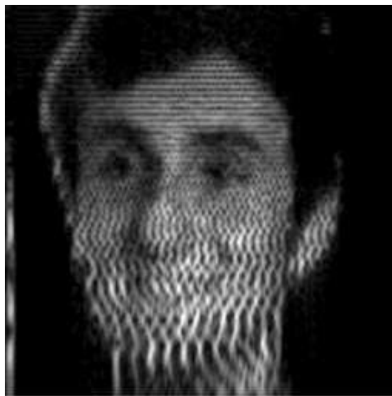
Figure 164 : Exemple de rendu d'une conversion image-son d'une seconde avec le dispositif The vOICe. Source : Auvray, 2006, p. 7
