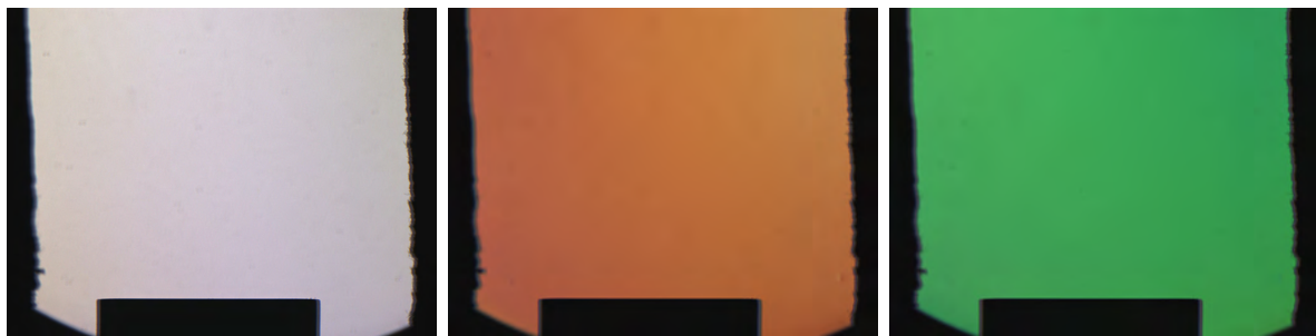
(a) Teinte blanche de la différence de chemin optique nulle. (b) Teinte orange correspondant à une différence de chemin optique connue. (c) Teinte verte correspondant à une autre différence de chemin optique.
