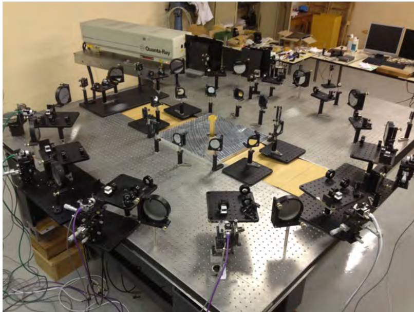
FIGURE 5.8 – Photo du montage d'interférométrie holographique numérique à 6 visées.
