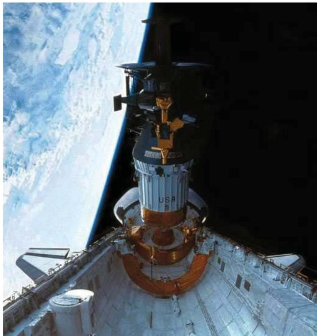
Figure 2.4 – Galileo monté sur une fusée à double étage en cours d'extraction de la navette spatiale Atlantis. Crédit : NASA et Lockheed Martin.
