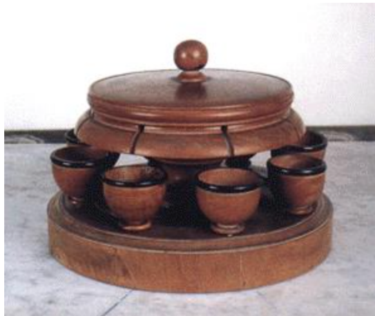
FIGURE 1.19 – Sismomètre inventé par Jean de Hautefeuille en 1703. Il s'agit d'un instrument en bois contenant un socle circulaire d'un diamètre de 12 cm. La coiffe est remplie de mercure et 8 gouttières y sont installées sur les 4 points cardinaux et 4 directions intermédiaires. Dessous, 8 récipients sont disposés pour récupérer le mercure lorsque celui-ci est déversé, c'est-à-dire en cas de mouvement sismique.
