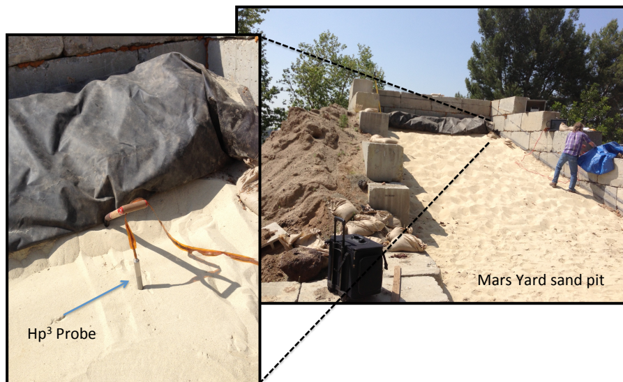
FIGURE 2.18 – Photo de la configuration de test dans du sable de type martien.
