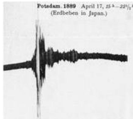
FIGURE 1.22 – Le sismographe de Ernst von Rebeur-Paschwitz était doté d'un système d'enregistrement optique sur papier photographique ce qui a permis d'obtenir en Allemagne ce signal sismique correspondant au séisme de 1889 au Japon (Knott 1889).
