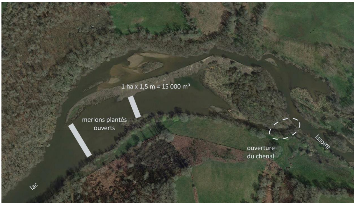
Figure 77 : Aménagement possible du delta pour piéger les sédiments
