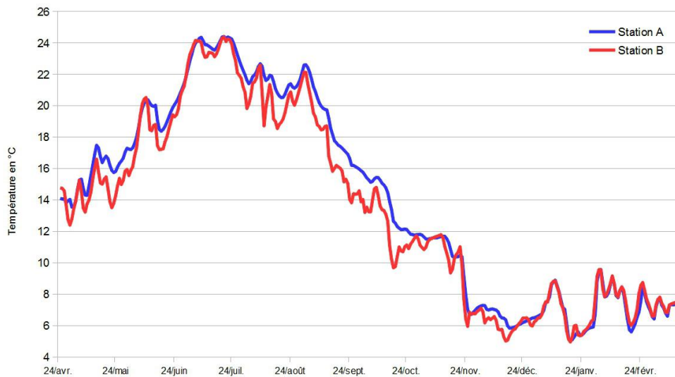
Figure 43 : Evolution des températures moyennes journalières au fond de la retenue au droit des stations A et B (avril 2015 - mars 2016)
