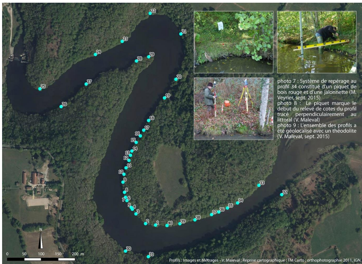
Figure 6 : Localisation des profils topographiques en fonction de la lithologie littorale
