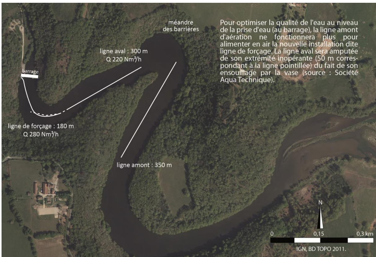
Figure 78 : Travaux d'optimisation de l'aération de lac de Saint-Germain-de-Confolens
