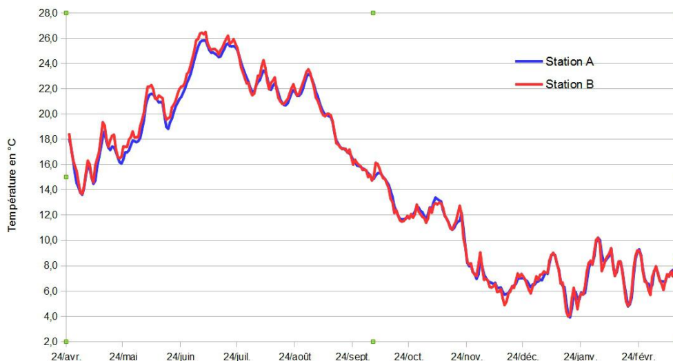
Figure 44 : Evolution des températures moyennes journalières en surface de la retenue au droit des stations A et B
