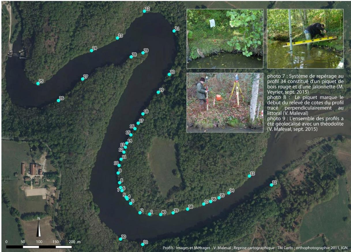
**Figure 6 : Localisation des profils topographiques en fonction de la lithologie littorale**
