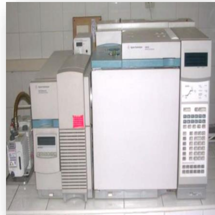
Photo 04 : Appareil de la CG / SM (C.R.D. Alphyte. Spa. Alger) (Mahfouf, 2015)
