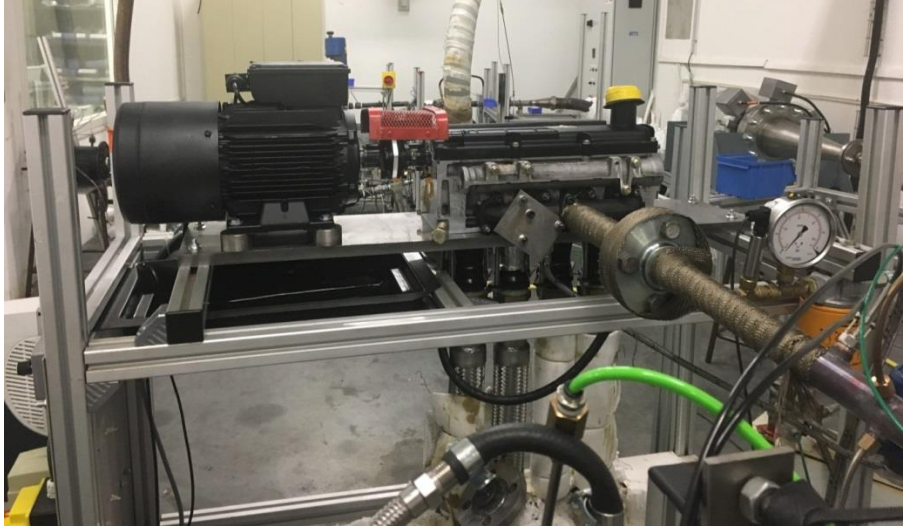
Figure II.15 – Banc culasse en amont du générateur thermoélectrique
