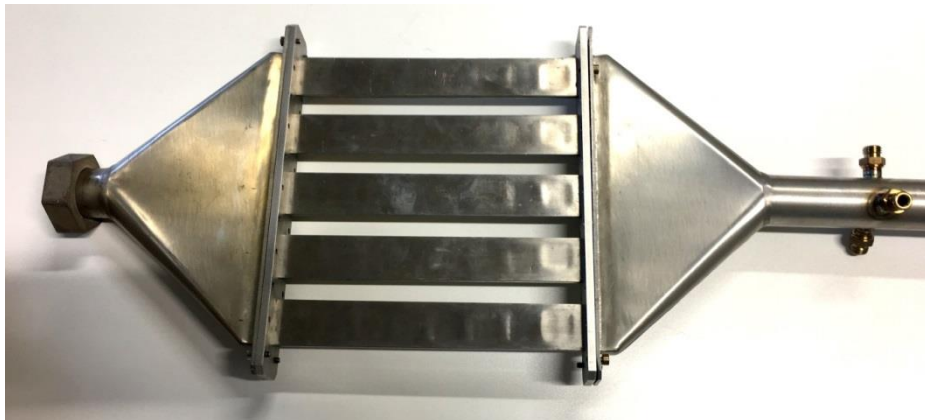
Figure II.3 - Echangeur cinq tubes
