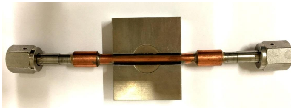
Figure II.4 - Echangeur froid, TEG monotube
