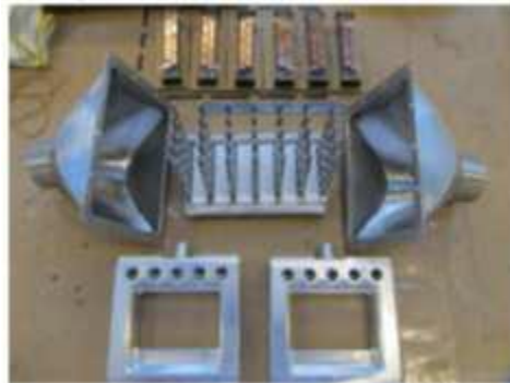
Figure I.18 Assemblage du générateur thermoélectrique du projet RENOTER II [93]
