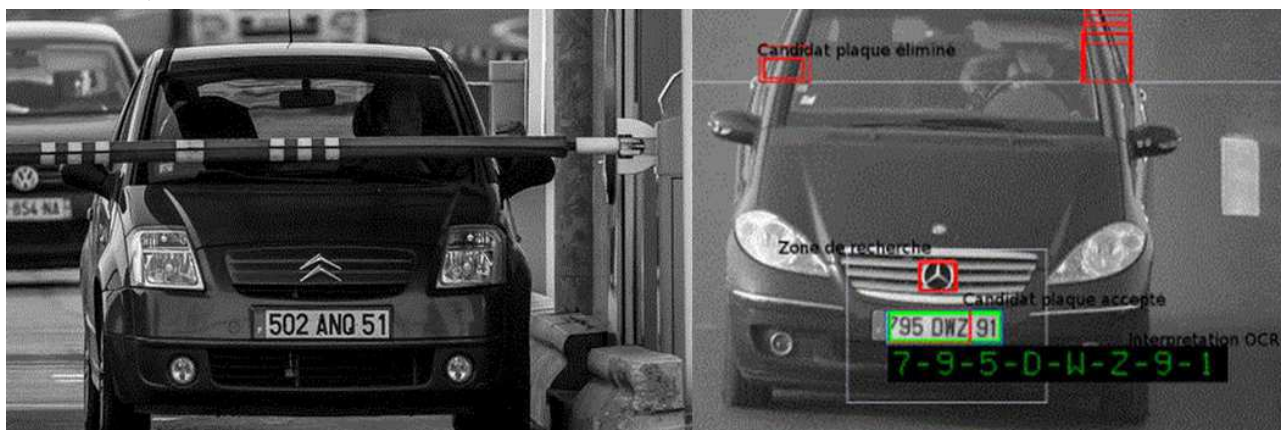
Figure 39 – Détection et reconnaissance de plaque simultanée sur deux voies (2-lane LPR).
