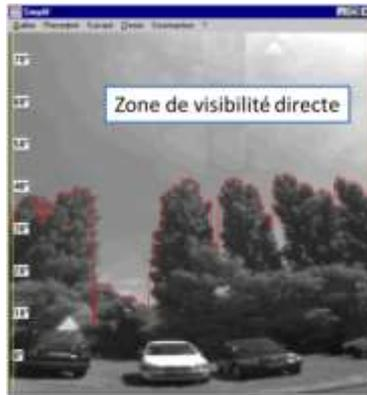
Figure 22. Distinction des satellites LOS grâce à la détection de la ligne d'horizon.
