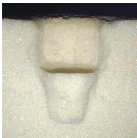
Figure III.32 : Bouchon de mousse densifiée
