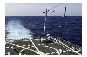
FIGURE 1.4 – Système de récupération Boeing Scaneagle. Source : U.S. Navy.
