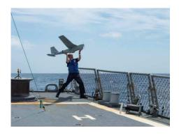
FIGURE 1.1 – Lancement d'un UAV à la main. Source : Business Wire.
