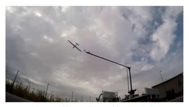
FIGURE 6.3 - Démonstration de lancement d'un UAV par le bras YAKA. vidéo : lancement.mp4
