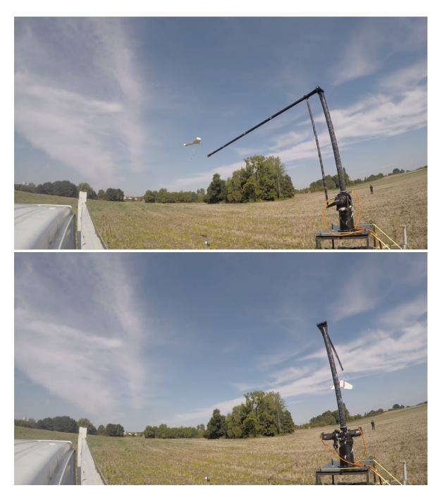
FIGURE 6.7 – Démonstration de récupération d'un UAV par le bras YAKA, depuis un camion fixe. vidéo : recuperation.mp4
