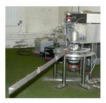
FIGURE 2.7 – Robot manipulateur flexible à un degré de liberté *Sheffield*, utilisé pour la modélisation ZAIN et collab. [2009].
