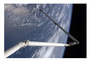
FIGURE 2.9 – Robot manipulateur spatial *Remote Manipulator System (RMS)* équipé de l'extension *Orbiter Boom Sensor System.* Ce système mesure 30 mètres, possède 6 degrés de liberté et pèse environ 500kg. Source : NASA (STS114-E-5330).
