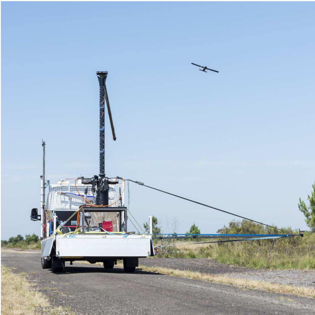
FIGURE 6.5 – Essais de récupération d'un UAV par le bras YAKA, depuis un camion mobile.
