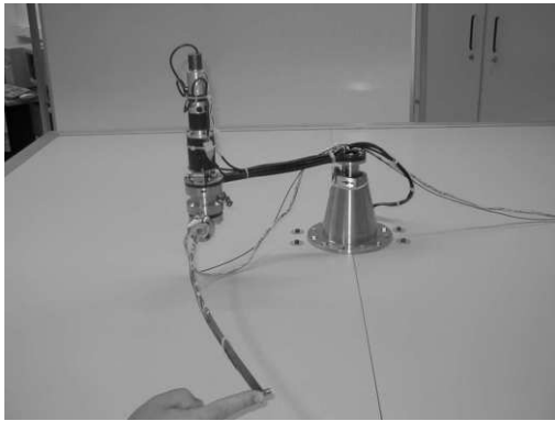
FIGURE 2.6 – Robot manipulateur flexible à deux degrés de liberté, mais ayant un seul segment flexible IST , conçu pour expérimenter des asservissements en effort TOKHI et AZAD [2017].
