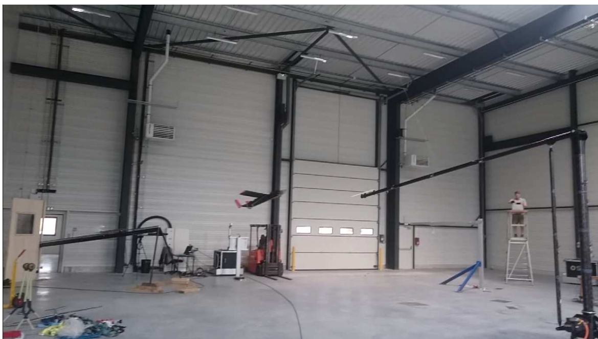
FIGURE 2.13 – Présentation du dispositif expérimental de test en intérieur : la catapulte (à gauche) lance un UAV (au centre) vers le robot YAKA (à droite) afin de recréer les conditions d’une récupération.
