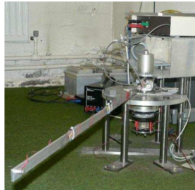
FIGURE 2.7 – Robot manipulateur flexible à un degré de liberté Sheffield , utilisé pour la modélisation ZAIN et collab. [2009].
