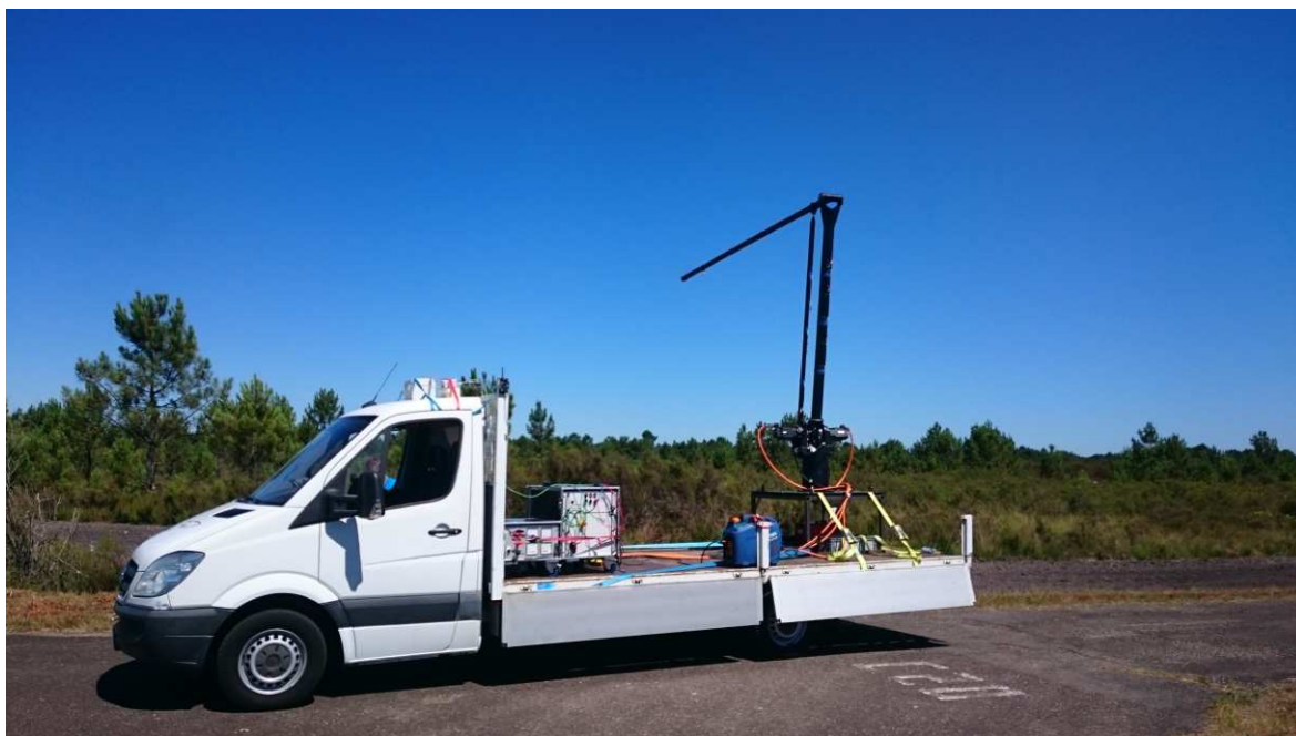
FIGURE 2.14 – Présentation du dispositif expérimental pour les essais opérationnels : le robot YAKA monté sur camion, capable de fonctionner en mouvement ou à l’arrêt.
