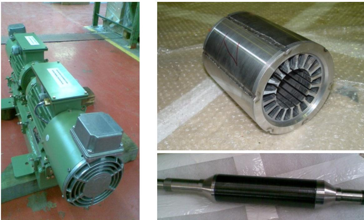
Figure 60 : Machines du Banc d'essais 30 000 tr/min
