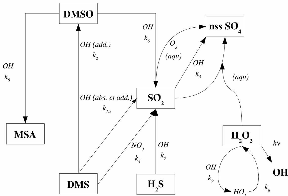
**FIG. 2.5:** Schéma initial d'oxydation du soufre dans LMD-ZT tel qu'il a été utilisé par Cosme et al. [2002]. Les flèches rectilignes et curvilignes représentent respectivement la chimie en phase gazeuse et aqueuse.
