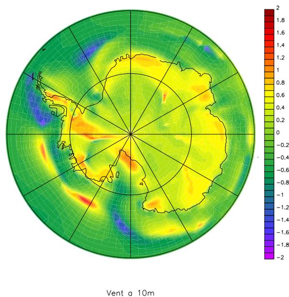
FIG. 3.7: Différences normalisées entre les vitesses de vent à 10 m calculées par 0k-A et 0k-orig
