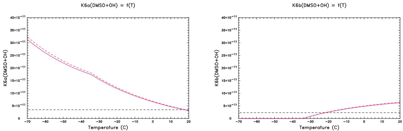
**FIG. 3.12:** Variations de la constante de vitesse  $k_6$  de la réaction (DMSO+OH) conduisant à la formation de  $SO_2$  (à gauche) et de MSA (à droite) en fonction de la température : en pointillés noirs, la chimie originale (0k-A) ; en rouge, la chimie 2004 (pointillés, 0k-B) et la chimie 2007 (ligne continue, 0k-ref).
