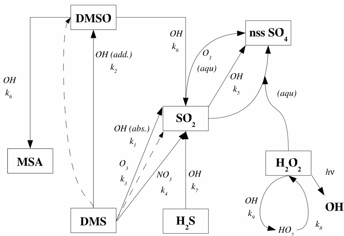
**FIG. 3.2:** Schéma d'oxydation du soufre dans LMD-ZT (version 4). Les flèches rectilignes et curvilignes représentent respectivement la chimie en phase gazeuse et aqueuse. Les flèches en pointillés représentent les réactions du DMS avec l'ozone, prises en compte dans la simulation 0k-C.
