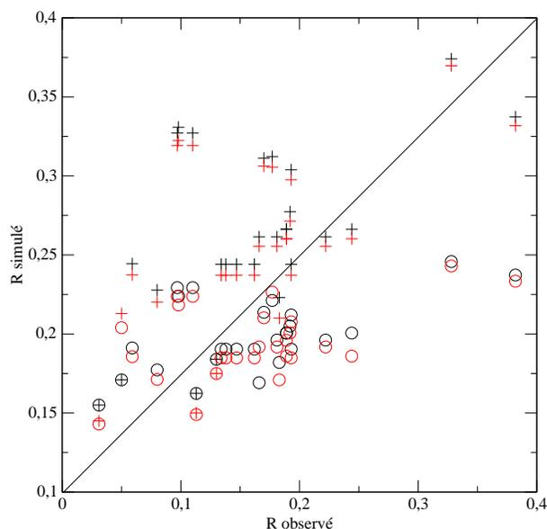
**FIG. 3.28:** Rapports  $R_{sim}$  (cercle) et  $R'_{sim}$  (croix) simulés versus  $R_{obs}$  pour différentes stations antarctiques répertoriés par Minikin et al. [1998]. En noir et rouge, respectivement, les données des simulations 0k-ref et 0k-D (avec sources anthropiques).
