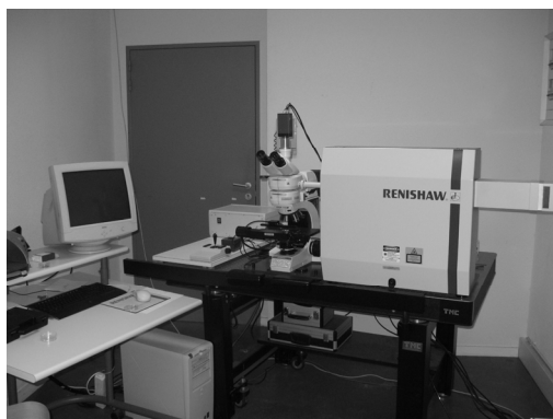
Figure 17 : Spectromètre Raman Renishaw RM 2000 associé à un microscope Leica DMLM du CRPAA.
