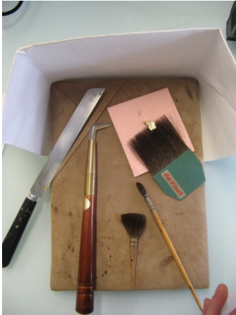
Figures 446 -447 : Les outils employés sont : le Chien d'assiette : poils chien de mer, poncer la surface et l'assiette ; le Sabre à dorer : couteau à dorer (1) ; la Palette à dorer : poils longs pour poser la feuille d'or (2) ; le Mouilleux : pinceau à l'aquarelle pour déposer l'assiette, détremper à l'eau et à la colle (3) ; l' Appuyeux : sert à plaquer la feuille d'or à l'assiette (4) ; la Pierre d'agate : très fragile pour polir à la détrempe (5) et le Coussin à dorer : peau de veau mort né : on couche la feuille, on coupe et geste rapide (6).
