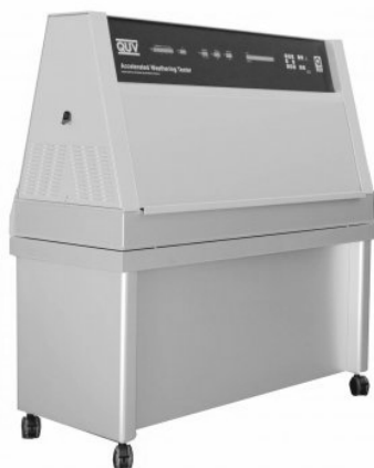
Figures 51 et 52 : Appareil (QUV-Panel de Q-LAB) ( http://www.labomat.eu/images/photos/img_60.jpg ) fournit des UVB centrées autour de 313 nm 400 heures, avec une température constante de 45°C. Irradiance spectrale de 0,71 W/m 2 .nm -1 pour une distance normale par rapport aux tubes de 4,5 cm.
