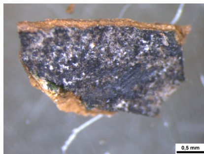
Figure 286 : Prélèvement de l'aile de l'ange sur fond rouge (BDX 14402) x25. Couche métallique noire, altération ?
