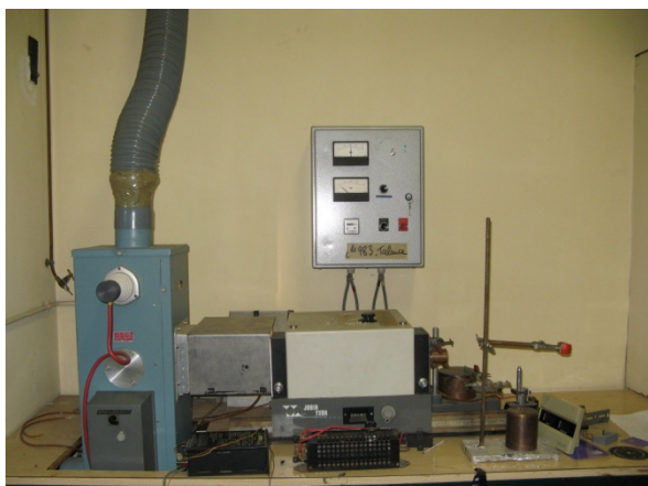
Figure 53 : Lampe à irradier de l'ISM de Bordeaux 1. Le système d'irradiation UV permet de choisir les longueurs d'onde d'irradiation et les focalisateurs.
