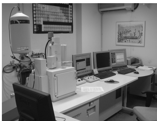
Figure 16 : Système de spectrométrie de rayons X en dispersion d'énergie couplé à un microscope électronique à balayage au CRPAA.
