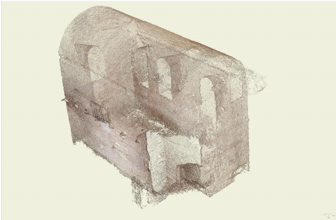
Figure 427 : Image réalisée à partir de PMVS 2. Nuage de points d'après le traitement des photographies. L'architecture se dessine.
