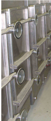
Figure 386 : Enceintes de fumigation.
