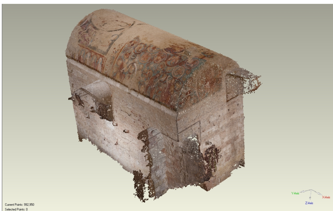
Figure 428 : Image réalisée à partir de PMVS 2. Nuage de points d'après le traitement des photographies à très haute définition (un milliard de points). La peinture apparaît sur la voûte.
