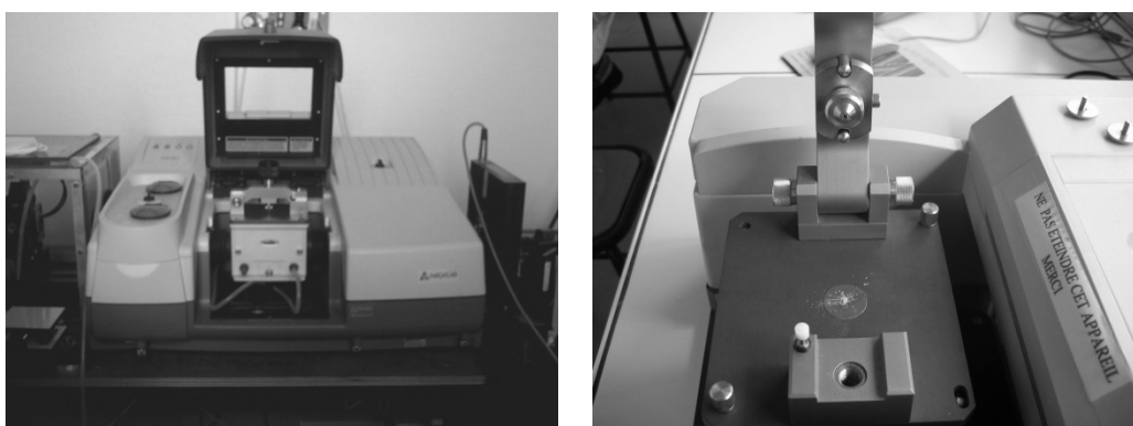
Figures 19 et 20 : Spectromètre IRTF de l'ISM et système de montage en ATR, l'échantillon est directement placé sur la cellule de diamant.
