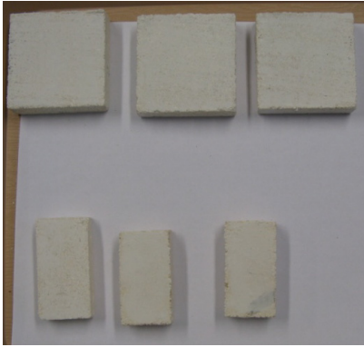
Figure 450 : Blocs de calcaire découpés et utilisés comme support à la dorure (carrés : détrempe ; rectangles : mixtion). Passage de Modostuc pour boucher les pores et homogénéiser la surface.
