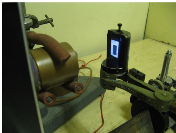
Figure 54 : Mise en place de l'échantillon face au faisceau UV. L'échantillon, ici l'huile de lin sur lame de verre est placée sur un porte échantillon situé à 17 cm de la source UV.
