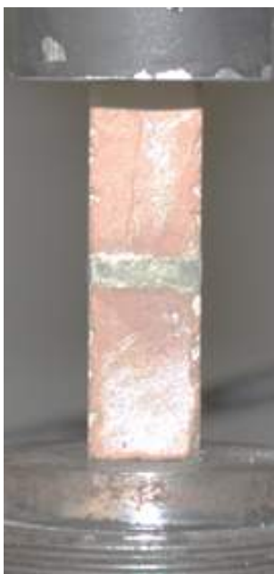
FIGURE 2.41: Photo des supports pour l'essai de compression.
