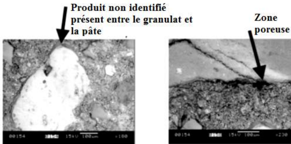
FIGURE 1.11: Images au MEB du béton de granulats humides [37]
