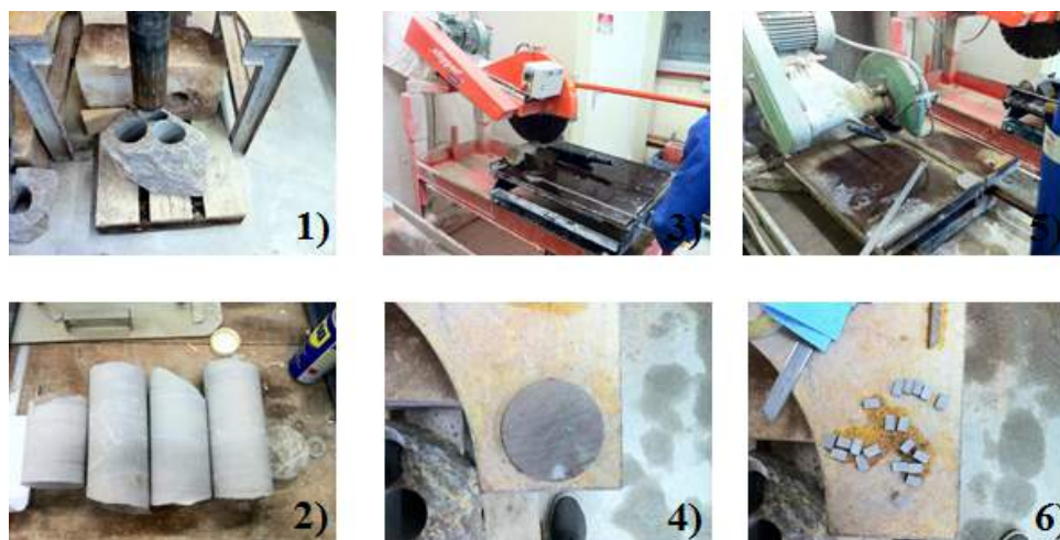
FIGURE 2.29: Etapes de fabrication des granulats
