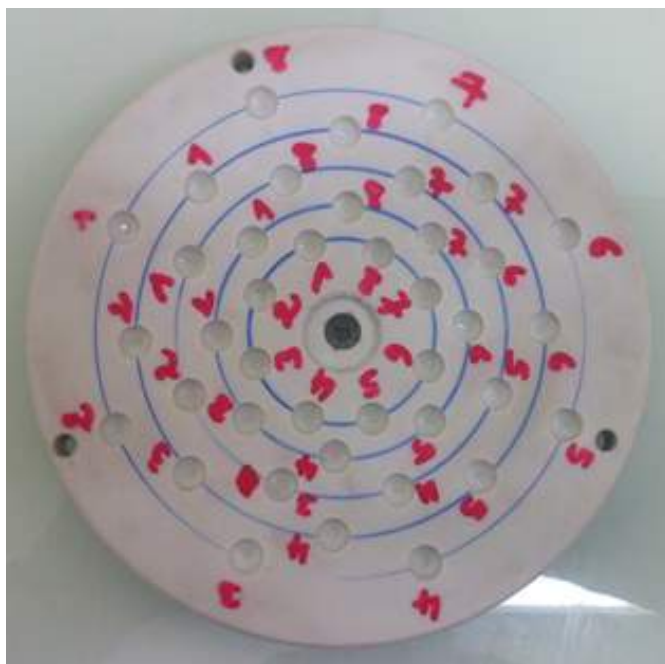
FIGURE 3.4: Support pour maintenir les échantillons avec les grains sphériques verticalement
