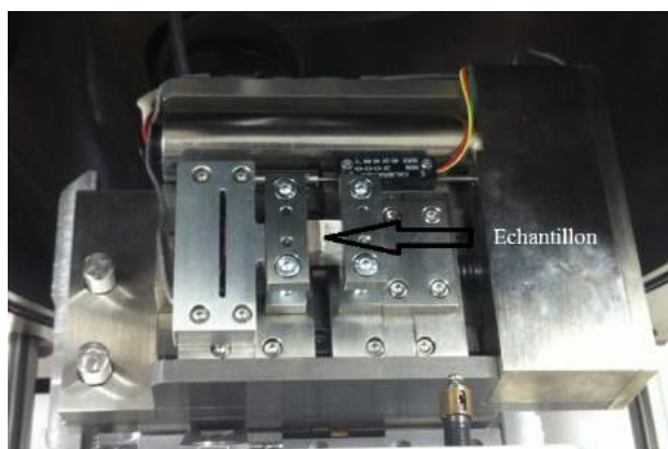
Photo d'un échantillon en environnement MEB destiné à la réalisation d'un essai de traction
