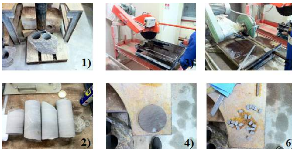
FIGURE 2.29: Etapes de fabrication des granulats
