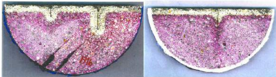
FIGURE 1.34: Profil de dégradation dans la section droite d'une éprouvette fissurée (cité par [116])
