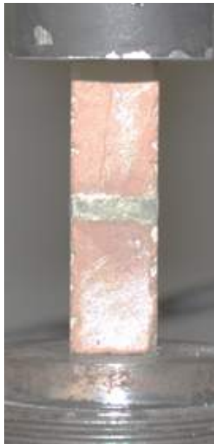
FIGURE 2.41: Photo des supports pour l'essai de compression.
