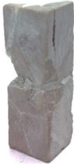
FIGURE 2.43: Photo illustrant le mode de rupture lors des essais de compression pour le composite
