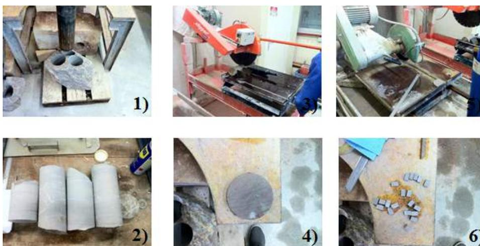
FIGURE 2.29: Etapes de fabrication des granulats
