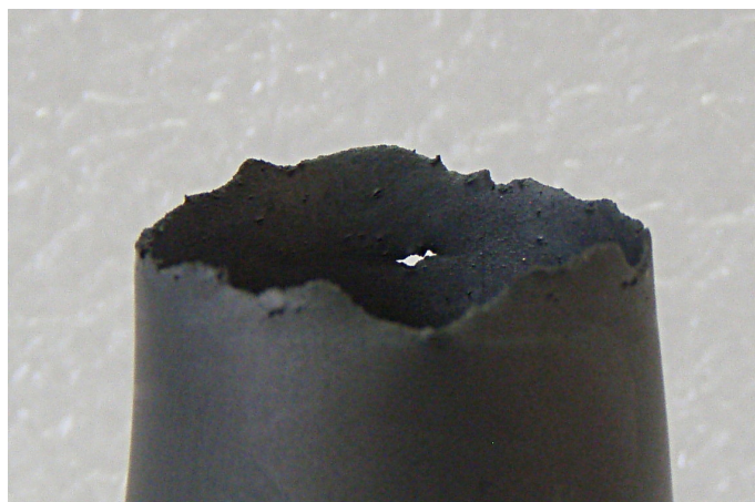
FIG. F.19: Planéité de la trajectoire de la fissure
