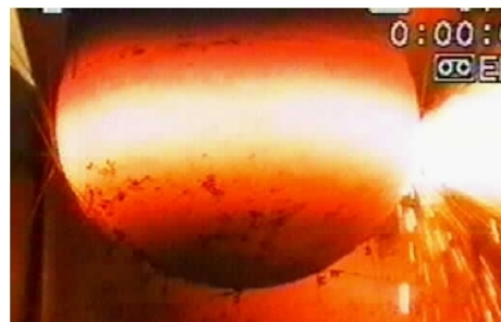
FIG. 1.15: FOREVER : rupture de l'éprouvette [ALS 05]
