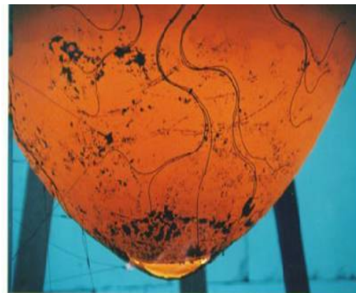
FIG. 1.10: Essais OLHF_2 : zoom sur la propagation de fissure [OLI 02]
