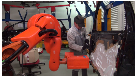
FIGURE 8.3 – Poste avec robot, c'est le robot qui se charge de la tâche d'adhésion de la feuille d'étanchéité, homme et robot sont amenés à partager l'espace de travail
