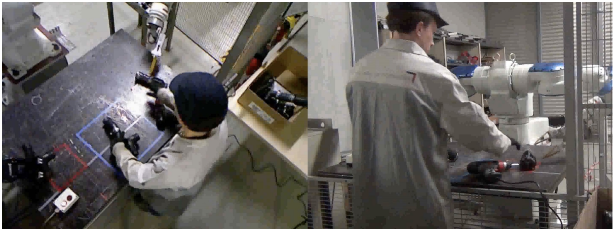
FIGURE 8.14 – Vue de haut et de côté d'une tâche de Kitting assistée par un robot. Le robot fournit une série de pièces à l'opérateur, pendant que celui-ci se charge de monter l'ensemble. La façon dont ce fait cet échange, ainsi que le niveau d'autonomie du robot dans la décision du moment où passer les pièces à l'opérateur est l'objet de cette étude.
