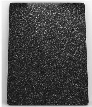
FIGURE 5.7 – Echantillon virtuel de peinture automobile basé sur le modèle de distribution de paillettes développé dans le projet. La peinture est déposée sur une plaque plane identique aux plaques réelles utilisées pour la comparaison visuelle. La micro-structure présentée en Figure 5.6 est répétée de façon à paver la surface de l’échantillon.
