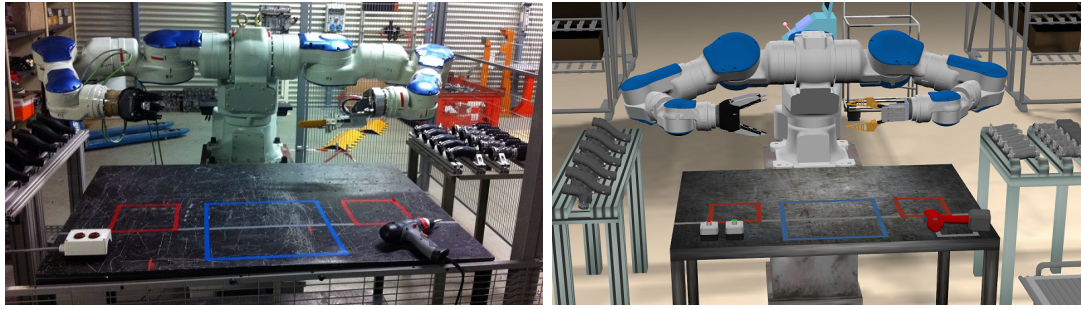
FIGURE 8.15 – La cellule expérimentale de collaboration homme-robot en situation réelle et en situation virtuelle
