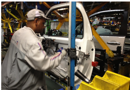
FIGURE 8.2 – Poste Initial, sans robot, l'opérateur doit poser une feuille d'étanchéité, pour en assurer d'adhésion sur la porte, il doit effectuer un mouvement de passage d'une roulette sur un gabarit, contraignant pour le poignet
