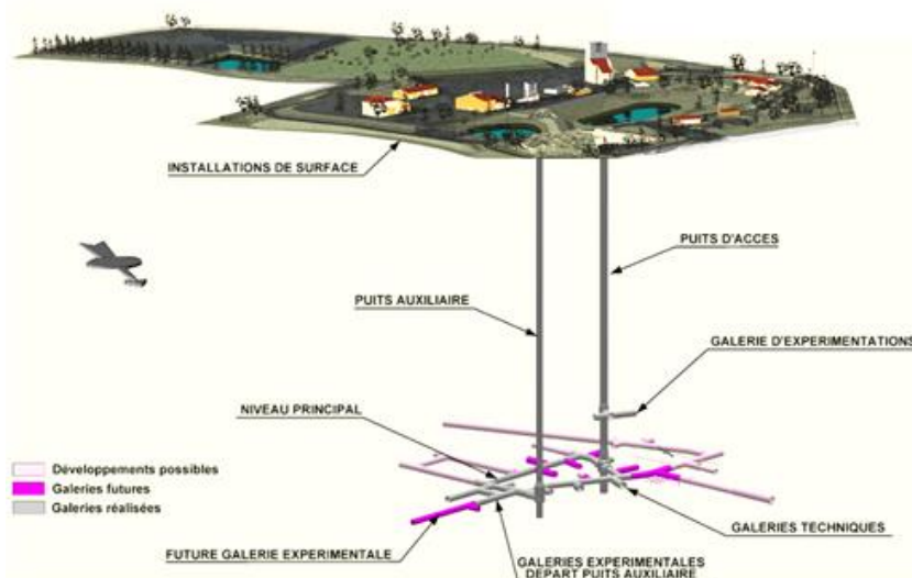
fig I-2 Installations de surface et souterraines autour des puits du laboratoire souterrain de Bure ( www.andra.fr )
