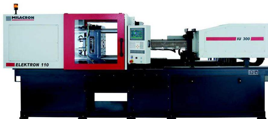
Figure II-18 : schéma de la presse à injecter MILACRON
