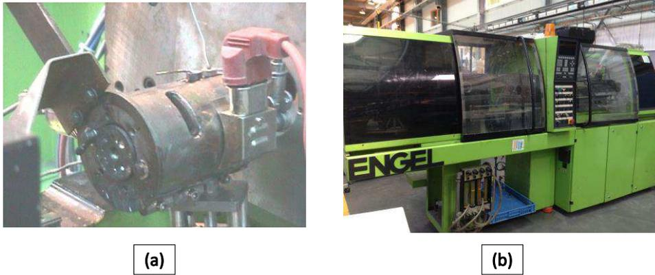
Figure II-5 : (a) Buse rhéométrique développée par E. Bonneau [77], (b) presse à injection hydraulique
