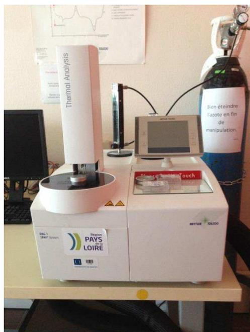
Figure II-2 : aperçu de l'appareil DSC de marque Mettler Toledo utilisé dans ce travail
