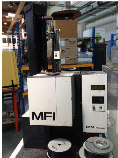
Figure II-4 : Aperçu de l'appareil utilisé pour la mesure du MFI (Melt Flow Index)
