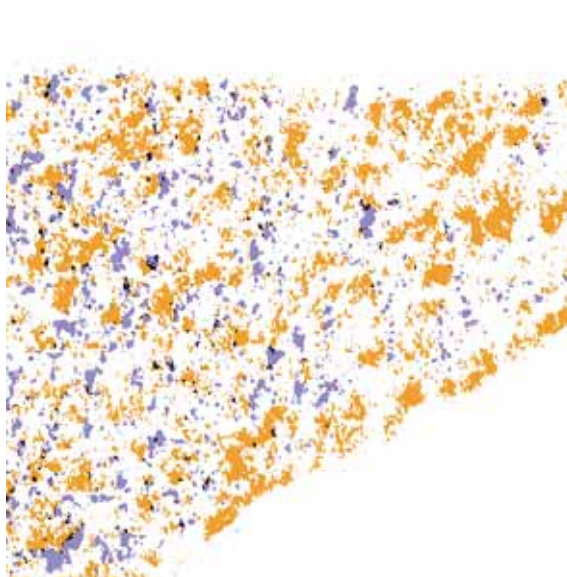
Figure 4.3.7 Image composite des images 4.3.6 du LL. Domaines parallèles (■) et perpendiculaires (■) au plan du dépôt. Les pixels communs correspondent au noir ■. Grandissement de 29500 x.
