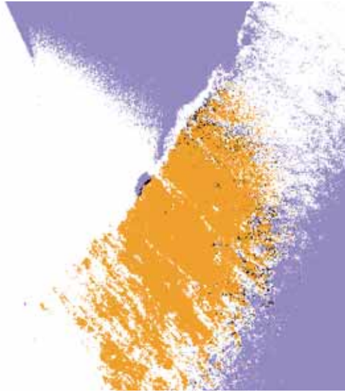
Figure 4.3.25 Image composite des images 4.3.24 du LRe traité à 1500 °C. Domaines parallèles (■) et perpendiculaires (■) au plan du dépôt. Les pixels communs correspondent au noir ■. Grandissement de 12000 x.
