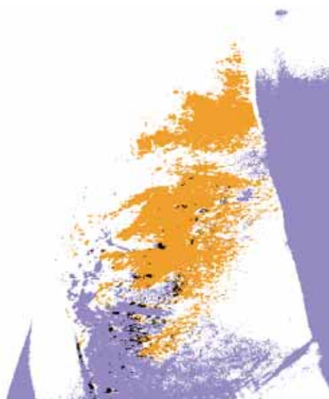
Figure 4.3.13 Image composite des images 4.3.12 du LR. Domaines parallèles (■) et perpendiculaires (■) au plan du dépôt. Les pixels communs correspondent au noir ■. Grandissement de 9100 x.
