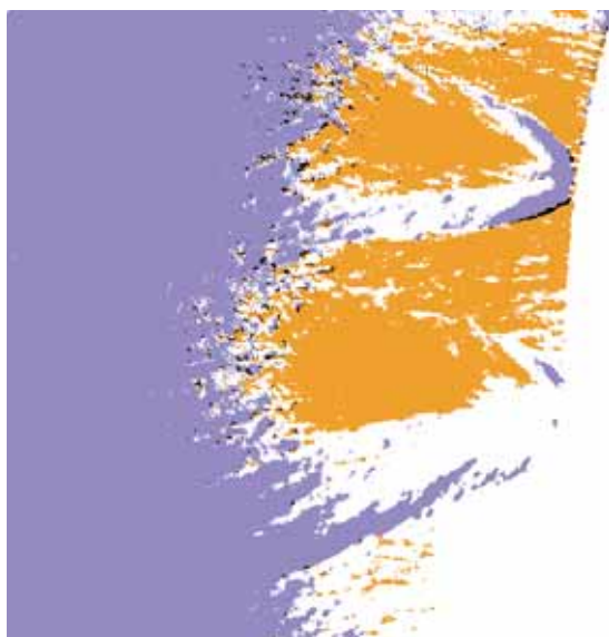
Figure 4.3.17 Image composite du LRe. Domaines parallèles (■) et perpendiculaires (■) au plan du dépôt. Les pixels communs correspondent au noir ■. Grandissement de 9100 x.
