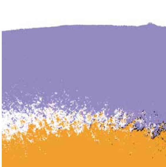
Figure 4.3.19 Image composite du LRe. Domaines parallèles (■) et perpendiculaires (■) au plan du dépôt. Les pixels communs correspondent au noir ■. Grandissement de 12000 x.
