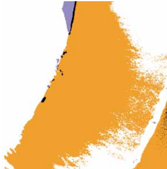
Figure 4.3.23 Image composite des images 4.3.22 du LRe traité à 1500 °C. Domaines parallèles (■) et perpendiculaires (■) au plan du dépôt. Les pixels communs correspondent au noir ■. Grandissement de 9100 x.
